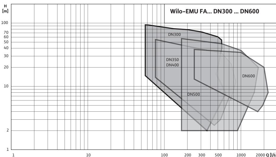
Характеристики согласно ISO 9906, приложение A. Указанный коэффициент полезного действия соответствует гидравлическому коэффициенту полезного действия.
